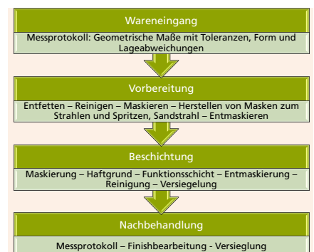
Ablaufschema Plasmaspritzen.
